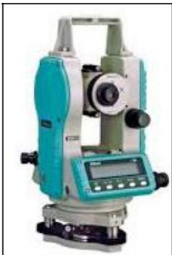
Digital Theodolite Nikon NE 100 - 5 atau 10 ° (5/10mgon, 0.01/0.02mil) membaca sudut, - 10 atau 20 ° (2/5mgon, 0.05/0.01mil) membaca sudut untuk NE-100 - Baterai mangan dengan 22 jam operasi (48 jam dengan baterai alkaline) - IPx54 tahan air - Tampilan yang jelas dan hawar dengan pencahayaan backlight - Antarmuka pengguna yang sederhana - iluminasi reticle - Teleskop terang 30x
